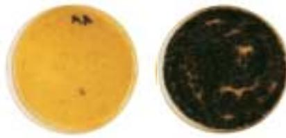
**Ob die Mittel Schimmelpilzsporen in einer Test-Suspension abtöten, zeigt sich nach dem Bebrüten der Nährböden. Links der Erfolg eines sehr guten Produkts. Bei einem mangelhaften Antischimmelmittel wachsen die schwarzen Pilze (Aspergillus niger) zahlreich weiter.**
