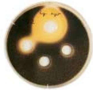
**Test auf sporenhaltigem Nährboden: In die ausgestanzten Löcher wurden die Mittel geträufelt – und zwar pur (oben), verdünnt (links 10fach, rechts 100fach), zum Vergleich Wasser (unten). Die Größe der nicht von schwarzen Pilzen bewachsenen „Hemmhöfe“ zeigt die Wirkung.**
